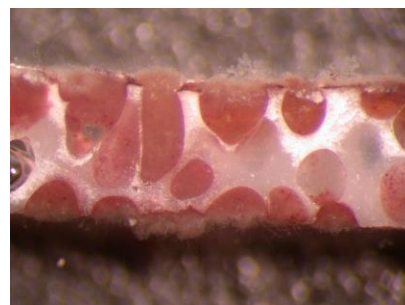
Querschnitt, mit Biofilmbewuchs
