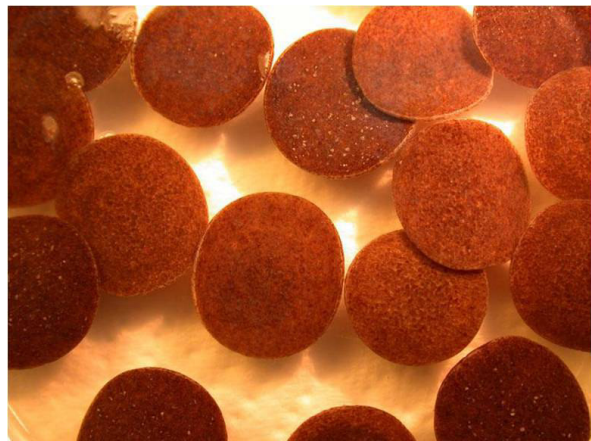
Bild 1 und 2: Mutag BioChip™-Hochleistungsträgermaterial für Biofilme – ungefärbt, ohne Biofilmbewuchs (weiß) und eingefärbt, ohne Biofilmbewuchs (orange)
